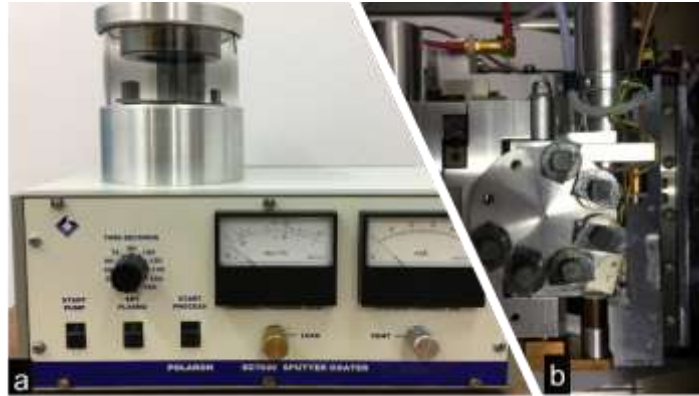
Şekil 3. 13: Örneklerin yüzeyini kaplamak için kullanılan Polaron Range püskürtme kaplayıcı ve SEM içine yerleştirilmiş yüzeyi altın paladyumla kaplanmış örnekler.
