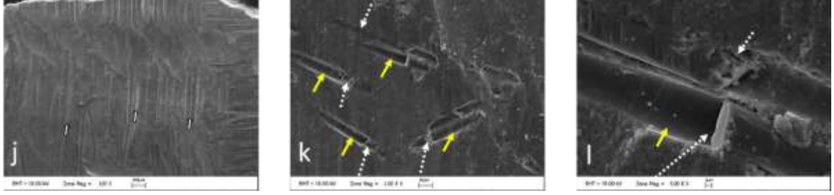
Şekil 4 8: %50 DMSO uygulanan örneğin x100 x1000 ve x5000 büyütmede SEM görüntüleri
