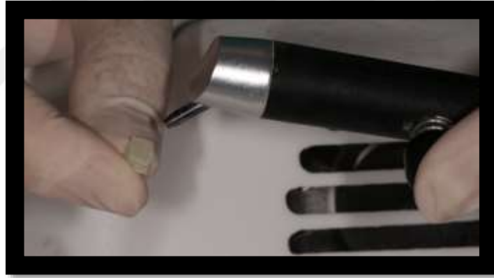
Şekil 3. 5: Örnek yüzeylerine air abrazyon uygulanması
