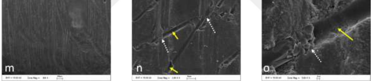
Şekil 4 9: %37 Fosforik asit + DMSO uygulanan örneğin x100 x1000 ve x5000 büyütmede SEM görüntüleri
