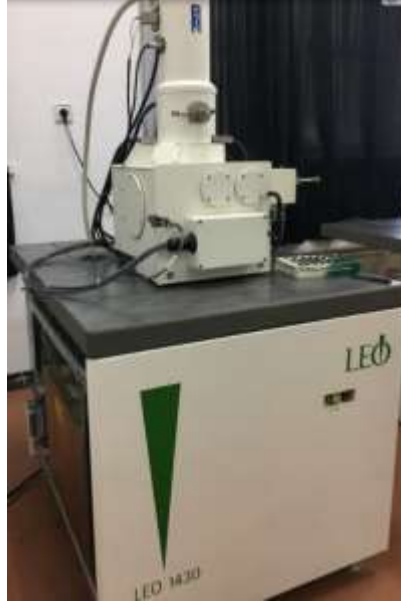
Şekil 3. 14: Çalışmada kullanılan ZEISS LEO-1430 VP SEM cihazı
