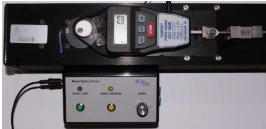
Şekil 3. 10: Çalışmada kullanılan Mikro gerilim bağlanma dayanıklılık test cihazı
