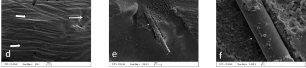
Şekil 4 6: Frez ile Pürüzlendirmenin ardından %37 fosforik asit uygulanan örneğin x100 x1000 x5000 büyütmede SEM görüntüleri
