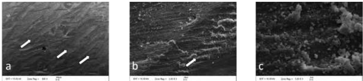
Şekil 4 5: Frezle pürüzlendirme dışında ilave işlem yapılmamış kontrol grubu örneğinin x100 x1000 ve x5000 büyütmede SEM görüntüleri
