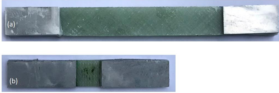
Şekil 4.7. (a) kayma numunesi, (b) fibere dik yönde basma numunesi.
