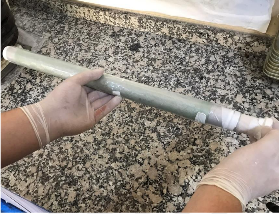
Şekil 4.11. Alçı kalıbın alüminyum tüp içine yerleştirilmesi.
