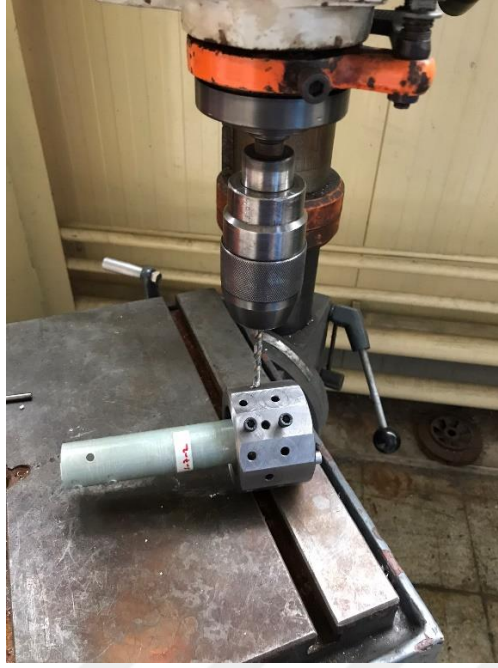
Şekil 4.15. Numunelere pim deliklerinin açılması.
