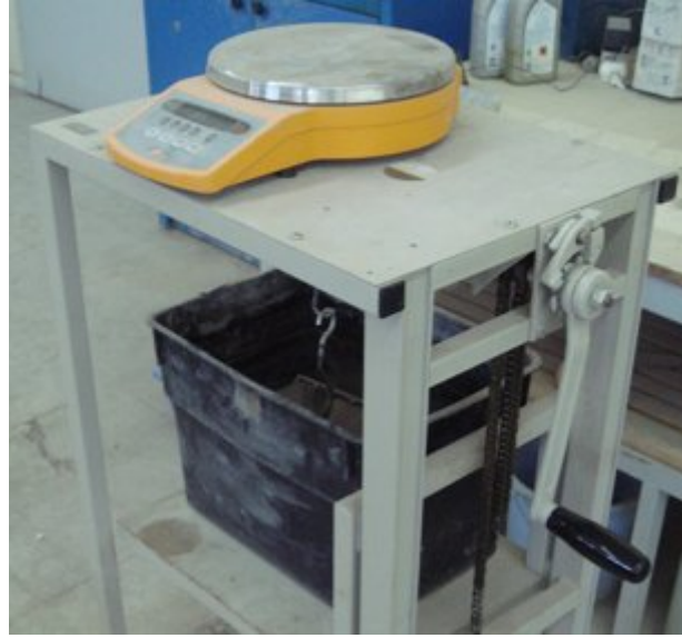
Şekil 4.7 Rölatif porozite deney düzeneği (Arşimet terazisi)
