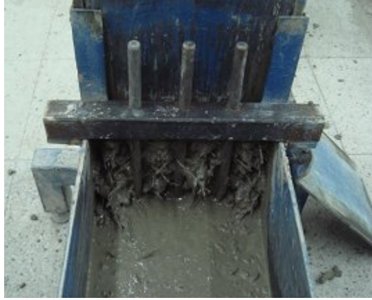
Şekil 5.2 Üç çubuklu L-kutusu deneyi sonucu bloklanma gözlenen 5 nolu FTKYB karışımı
