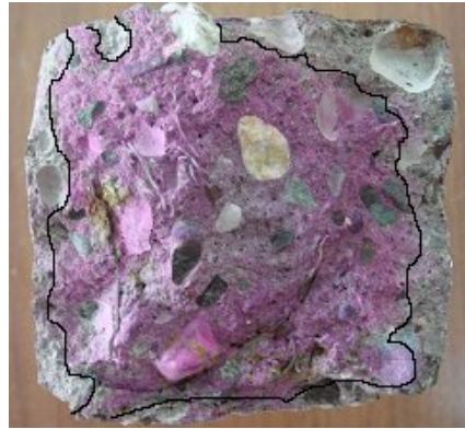
Şekil 5.163 Islanma-kuruma deneyi uygulanan FTKYB serisinin karbonasyon deneyi sonrası görünümü
