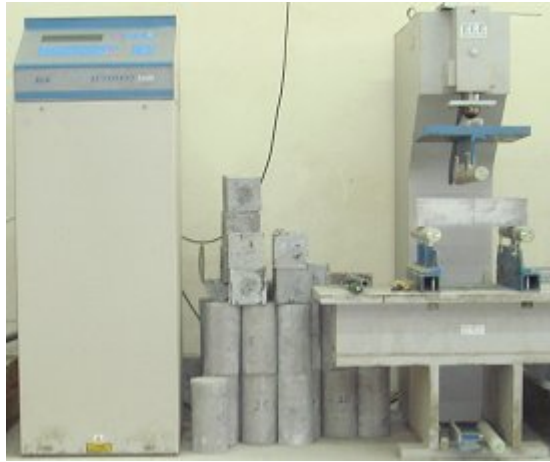
Şekil 4.6 Yük kontrollü eğilmede çekme deney aleti
