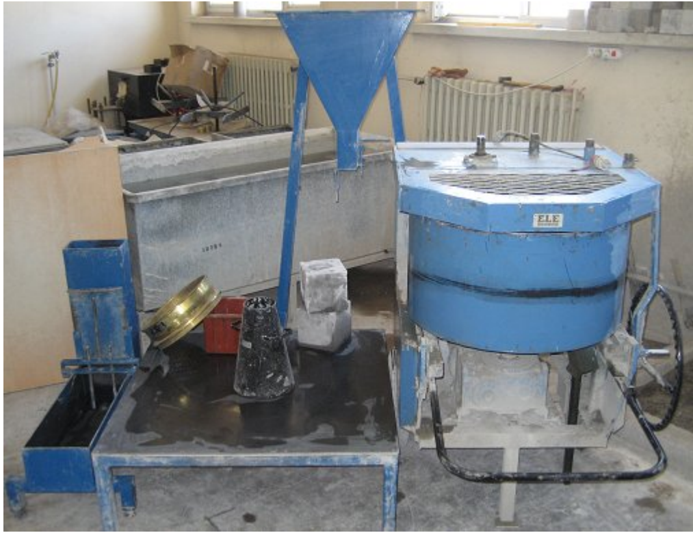
Şekil 4.3 Taze beton deneylerinde kullanılan deney alet ve aparatları (L-kutusu, çökme yayılma tablası, çökme hunisi, V-hunisi ve karıştırıcı)
