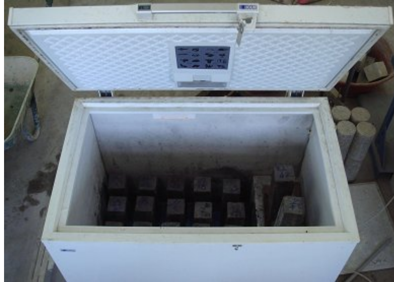
Şekil 4.10 Donma-çözünme deneyinde kullanılan dondurucu alet
