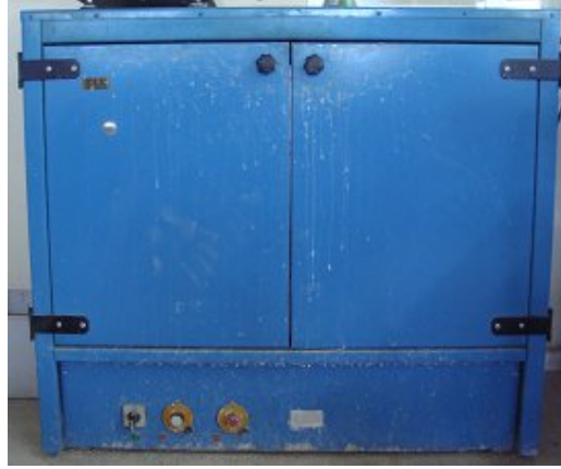
Şekil 4.13 Islanma-kuruma deneyinde kullanılan ayarlı fırın
