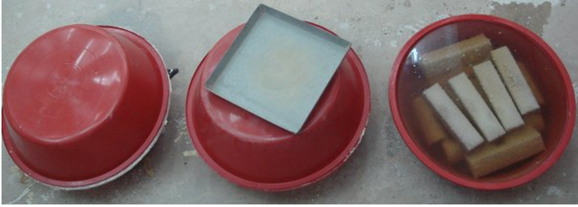
Şekil 4.11 Asit dayanıklılık deneyi düzeneği
