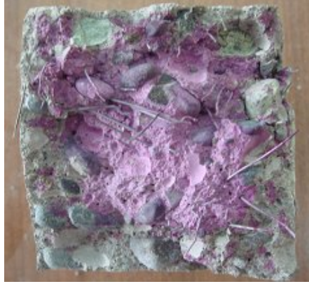
Şekil 5.161 Yüksek sıcaklık (300°C) uygulanan FTKYB serisinin karbonasyon deneyi sonrası görünümü
