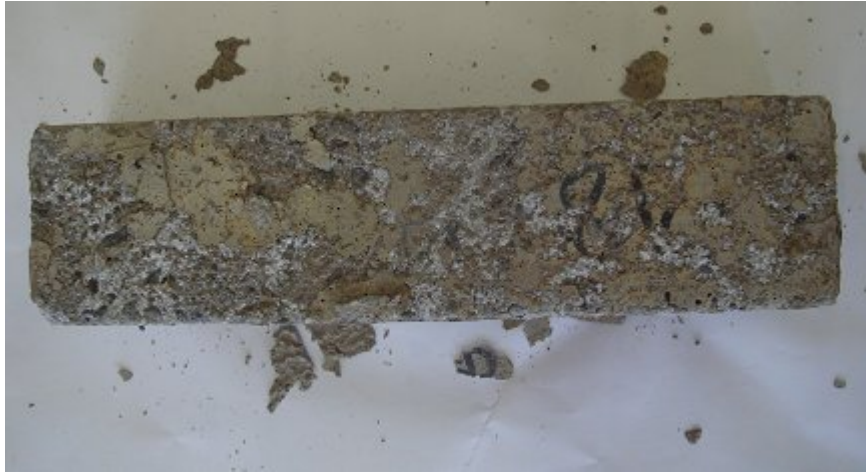
Şekil 5.130 Kiriş numune yüzeyinde pullanma sonucu beton dökülmesi
