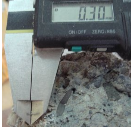
Şekil 5.53 900°C sonrası çelik fiber çapındaki küçülme (ölçüm uygulanan fiber normal çapı:0.55 mm)
