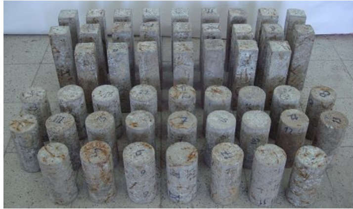
Şekil 4.14 Islanma-kuruma deneyi sonrası bazı numunelerin görünümü
