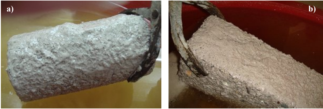
Şekil 4.12 Asit dayanıklılığı testi sonrası aşınmış olarak çıkarılan numuneler; a) silindirik, b) prizmatik numune
