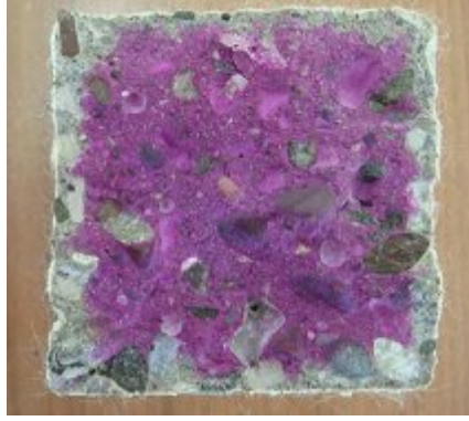
Şekil 5.162 Asit etkisine maruz bırakılmış FTKYB serisinin karbonasyon deneyi sonrası görünümü
