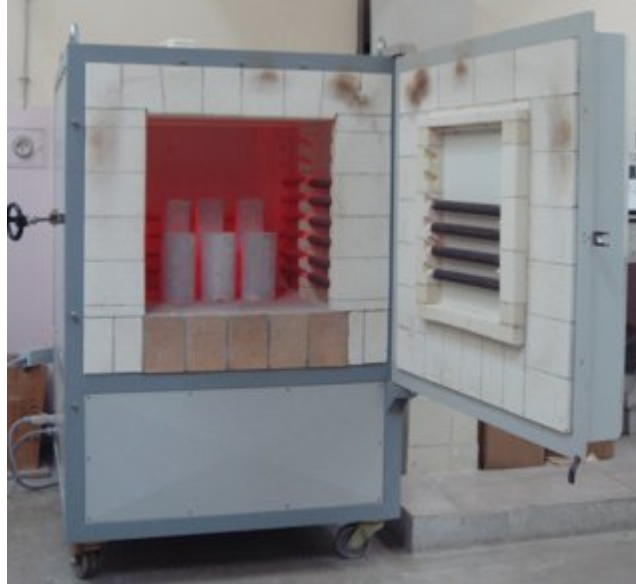
Şekil 4.9 Yüksek sıcaklık deneyinde kullanılan laboratuvar tipi fırın
