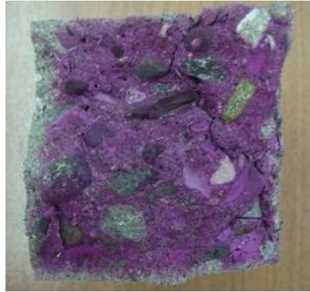
Şekil 5.159 Normal şartlar altında bulunan FTKYB serisinin karbonasyon deneyi sonrası görünümü
