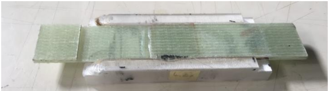
Şekil 4.6. Numunenin fiber takviyeli yapıştırıcıyla birleştirilmesinden sonra kalıba oturtulması
