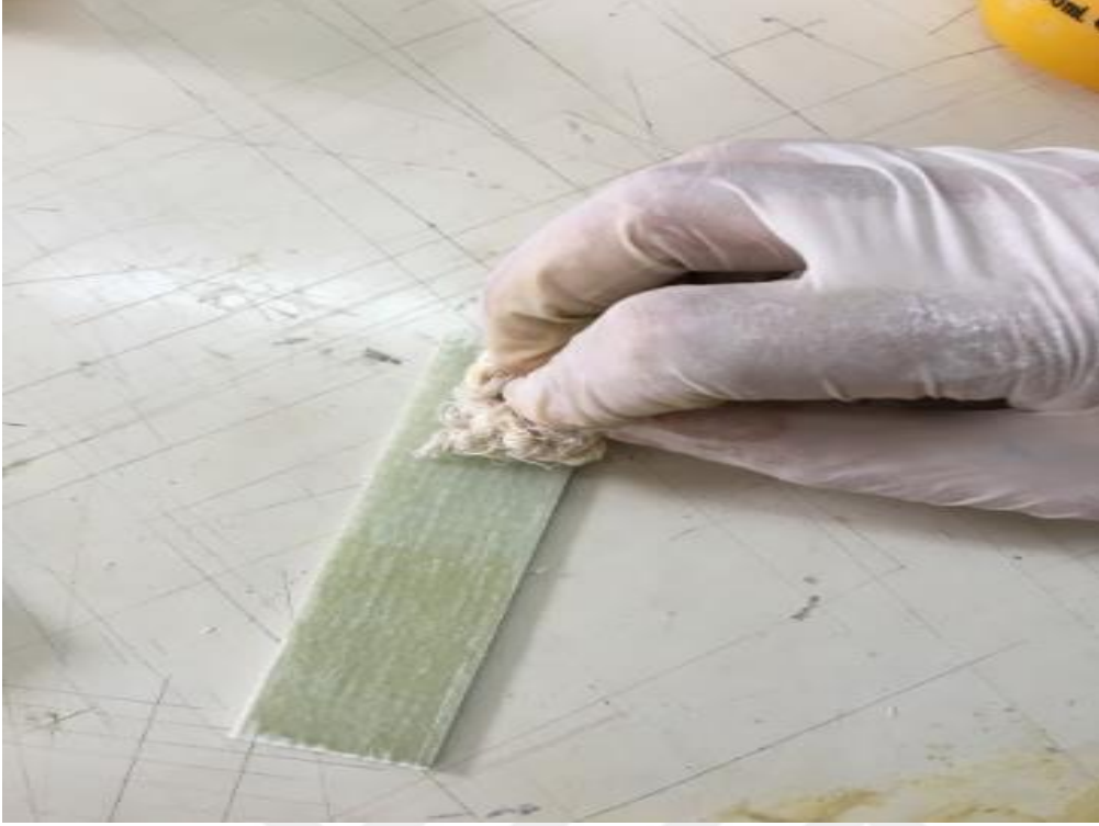
Şekil 4.4. Zımparalanan levhanın asetonlu üstübüyle temizleme işlemi
