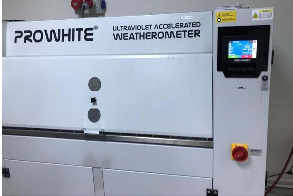
Resim 11. UV Hızlandırılmış Yapay Yaşlandırma Cihazı
