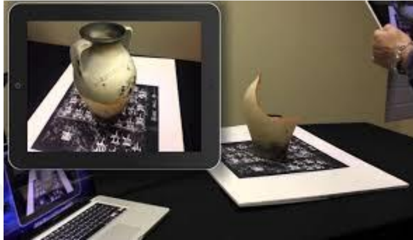
Şekil 5: Parçalanmış bir vazoyu birleştiren Artırılmış Gerçeklik uygulaması
