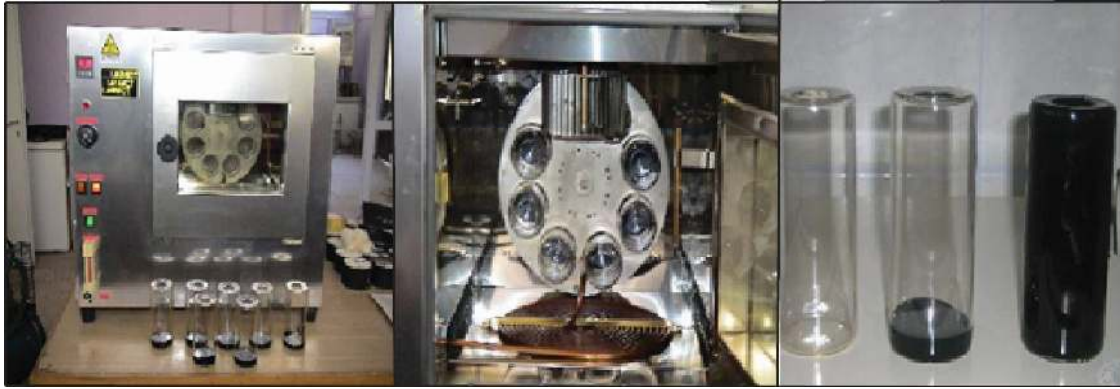
Şekil 3.2. Dönel ince film halinde ısıtma deneyi
