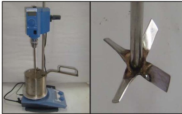
Şekil 4.3. Modifiye bitüm mikseri ve karıştırma başlığı
