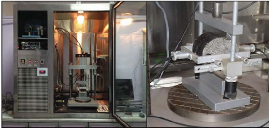
Şekil 3.12. UMATTA cihazı ve ITSM deney düzeneği
