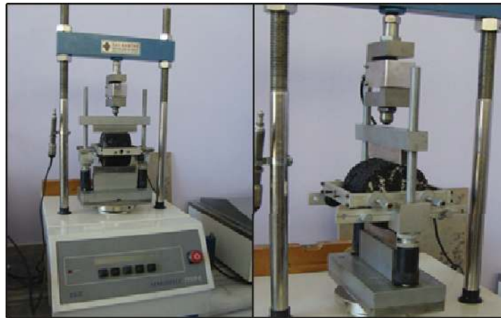
Şekil 3.11. Çekme dayanımı deney düzeneği
