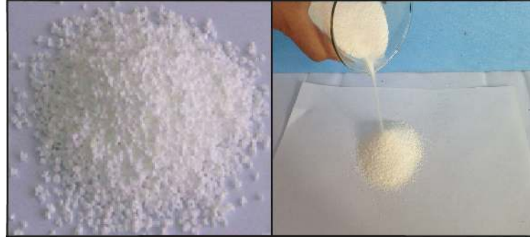
Şekil 2.3. SBS'in granül ve toz hali
