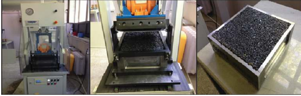
řekil 3.13. Merdaneli sıkıřtırıcı ve numune hazırlanması
