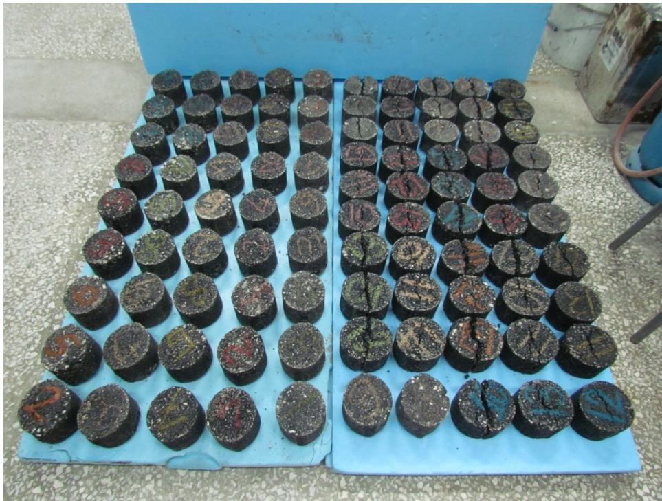
Şekil 4.25. Marshall ve yorulma deneyine tabi tutulan numuneler
