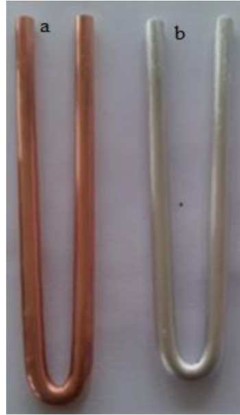
Şekil 3.10. Kaplanmamış haldeki a) bakır TF b) alüminyum TF
