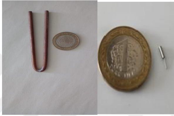
Şekil 2.1. Büyük ölçekli akort çatalı (TF) ve küçük ölçekli kuvars akort çatalı (QTF) boyutsal karşılaştırma
