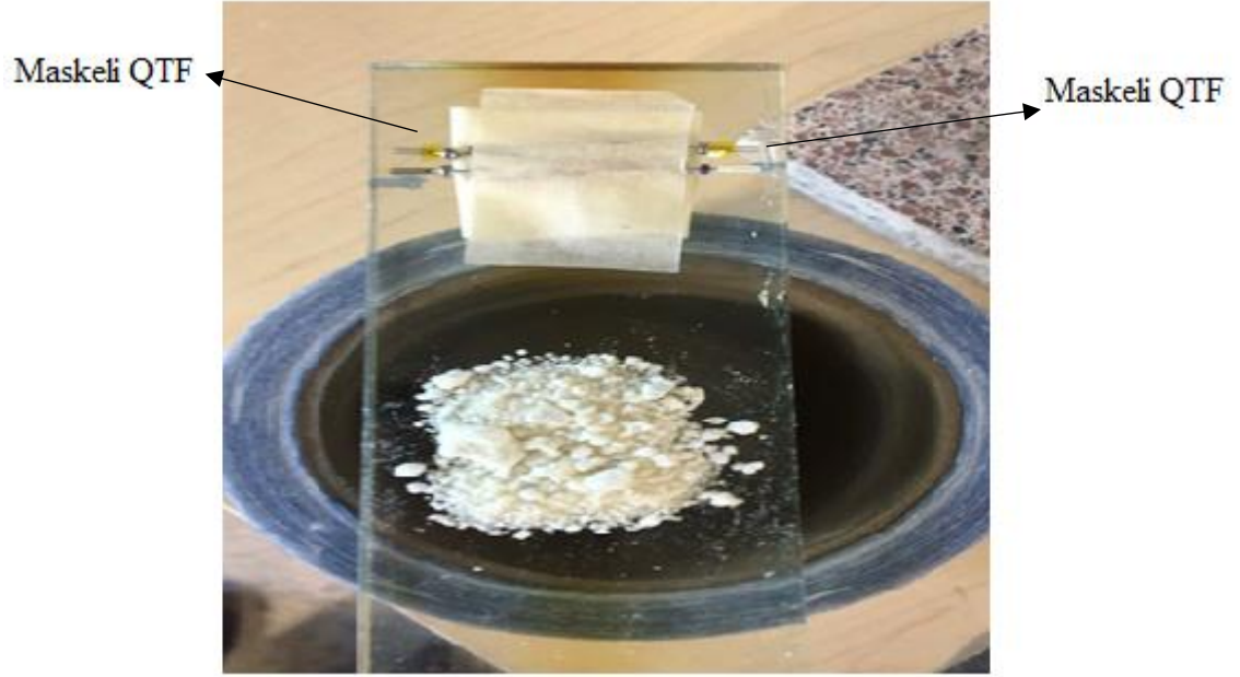
Şekil 3.17. Cam sehpa üzerinde konumlandırılan maskeli ve maskesiz QTF' ler ve 11-MUDA kimyasalı
