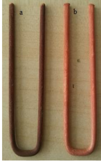
Şekil 3.14. a) Aşındırılan bakır TF b) Kaplanan bakır TF
