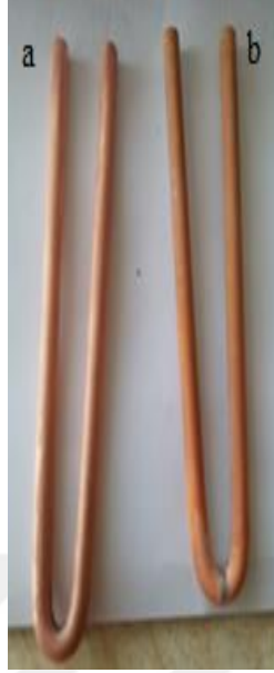
Şekil 3.11. a) Aşındırılan bakır TF b) Kaplanan Al TF
