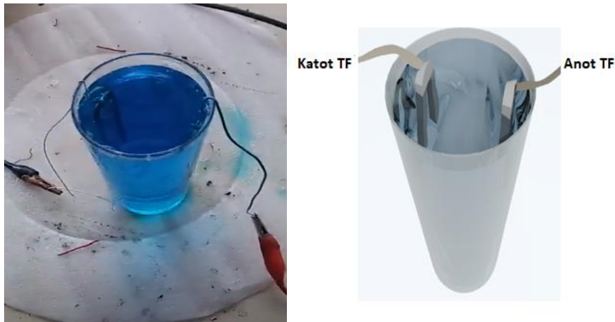
Şekil 3.3. Anot ve katodun bir bardak içerisinde birbirine paralel konumlandırılmış birinci deney düzenek geometrisinin gerçek ve 3 boyutlu şematik gösterimi
