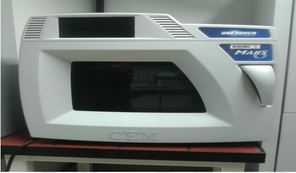
Şekil 3.14. Araştırmada kullanılan MARS 6 Xpress-Aufschluss-Vessels-Mikrodalga cihazı
