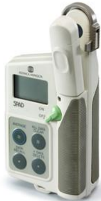
Dauererregung Chlorophyll Fluorimeter (170 x 85 x 40 mm), (565gms)
