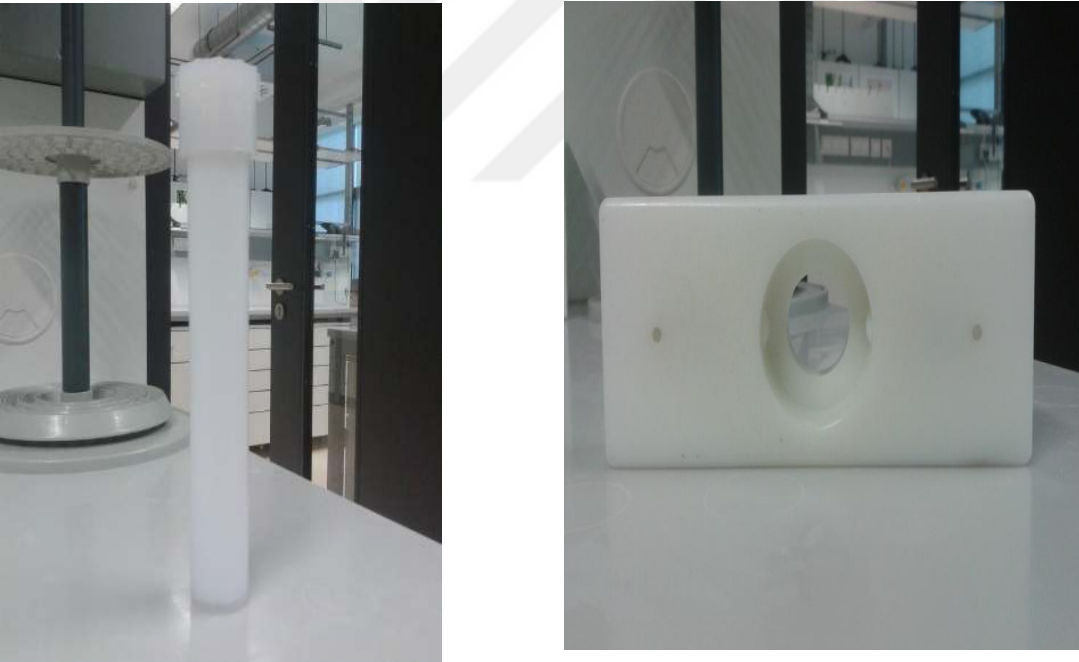
Şekil 3.15. Araştırmada kullanılan MARS 6 Mikrodalga cihazına ait bir materyal tüpü ve tıkaç açacağı
