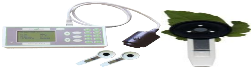
Şekil 3.13. Denemede kullanılan Konica Minolta SPAD -502 plus klorofil ölçme cihazı
