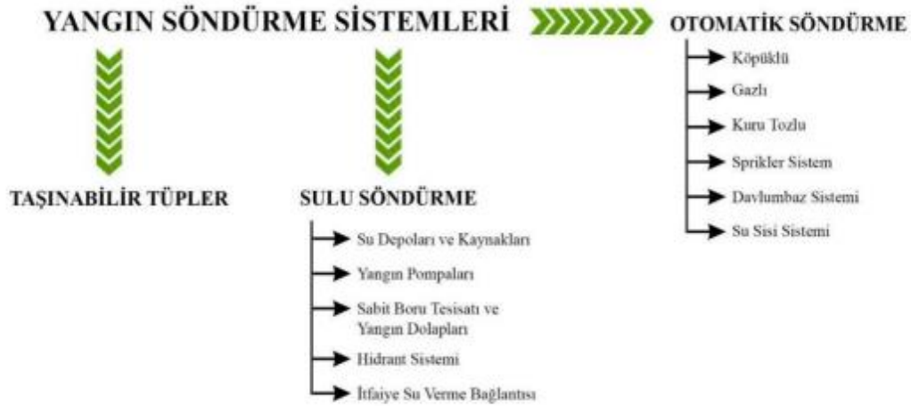
Şekil 4.5. Yangın söndürme sistemleri
