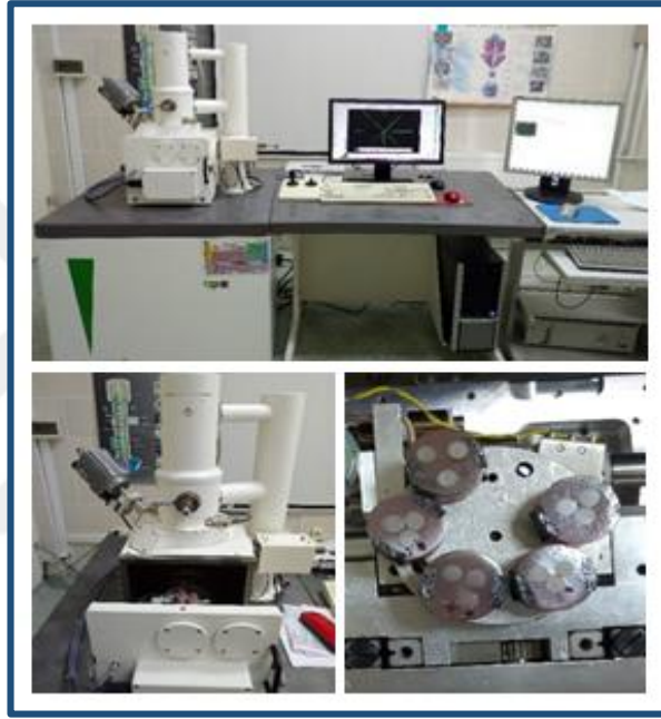
Şekil 3.18: Taramalı elektron mikroskobu (LEO 1430 VP, Cambridge, İngiltere).
