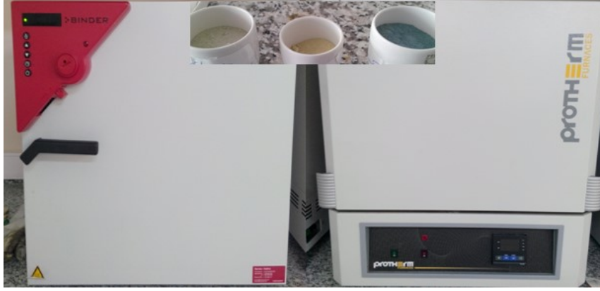
Şekil 3.7 Katkılı kalay oksit tozların kurutulduğu (soldaki resim) ve kalsinasyon işlemi yapıldığı (sağ resim) fırınlardan görünüm. Üstte ortadaki resim, krozeler içerisine konulmuş katkılı kalay oksit tozlar (Kişisel arşiv, 2015)
