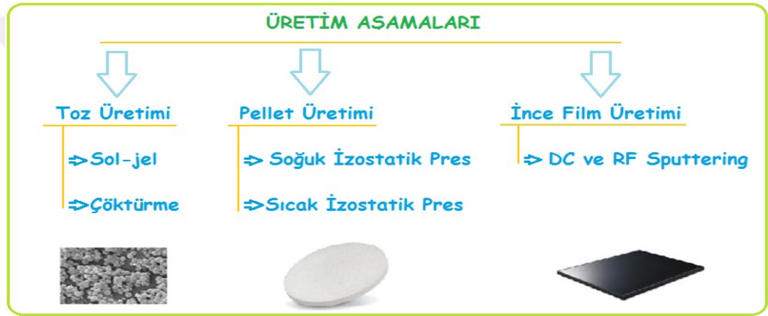
Şekil 3.1 Rutenyum (Ru), antimon (Sb) ve vanadyum (V) katkılı ve katkısız kalayoksit ( \text{SnO}_2 ) tozların, peletlerin ve filmlerin üretim akışı şeması
