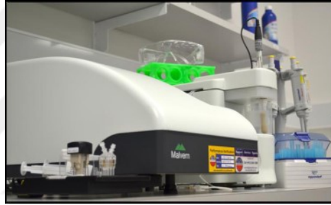
Şekil 3.17 Partikül boyut dağılım analizi cihazı (Karakterizasyon lab., EMUM) (Kişisel arşiv)
