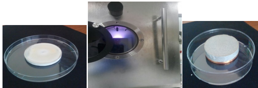
Şekil 3.13 Ortada RF Sputter işlemi sırasında cihazda oluşan plazmanın kabin dışından görüntüsü [Soldaki resim laboratuvar ortamında üretilmiş olan kalay oksit pelet; sağdaki resim ticari olarak satın alınan kalay oksit target] (Kişisel arşiv, 2017)
