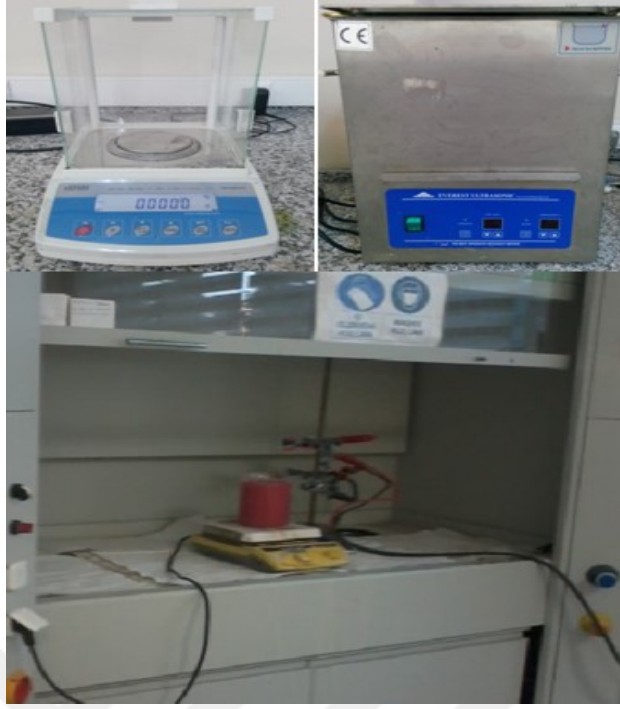
Şekil 3.5 Tozların hazırlığı. Hassas terazi (sol üst), Ultrasonik temizleyici (sağ üst), Çeker ocak içerisinde manyetik sıcak tabla üstünde katkılı (rutenyum-pembe) kalay oksit toz üretimi (Kişisel arşiv, 2015)
