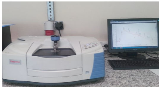
Şekil 3.21 FT-IR Cihazı (Karakterizasyon Lab., EMUM) (Kişisel arşiv)
