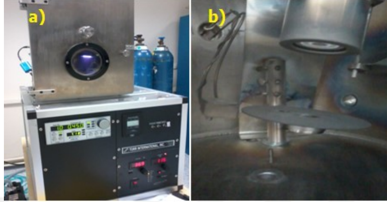
Şekil 3.11 a) Sn filmlerin üretimi için kullanılan Torr marka DC Sputter cihazı. b) DC Sputter vakum odası [Anot altlık (üzerinde cam numuneler), katot Sn target (üstte)] (Kişisel arşiv, 2017)
