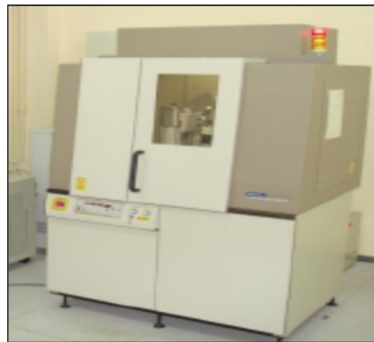
Şekil 3.19 X-ışınları difraksiyonu cihazı(XRD lab.,DEÜ) (Kişisel arşiv)
