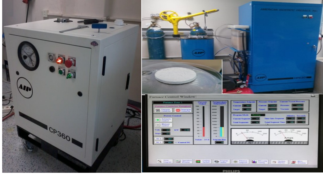
Şekil 3.10 CIP (Soğuk İzostatik Presleme) makinası (sol resim) ve HIP (Sıcak İzostatik Presleme) makinası (sağ üst mavi) ve sıcak izostatik pres makinası otomasyon kontrol paneli (sağ alt resim) (Kişisel arşiv, 2016)
