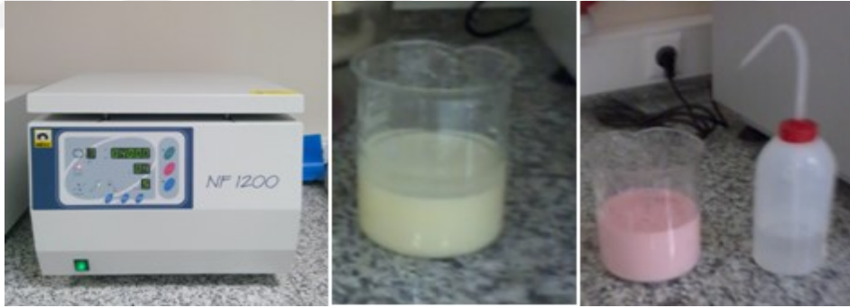
Şekil 3.6 Katkılı kalay oksit çökteltilerin (antimon-orta resim, retenyum-sağ resim) santrifüjde (solda) yıkama işlemi (Kişisel arşiv, 2015)
