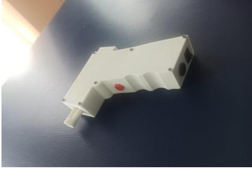
Fotoğraf 4.3 Load Cell ölçüm yapılı algometre
