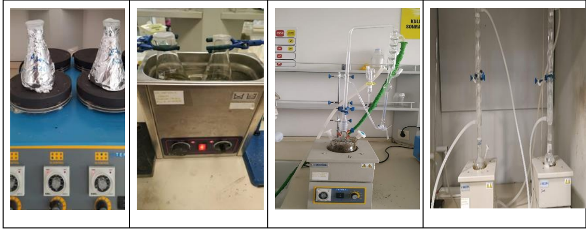
Şekil 4.3. Ekstraksiyon işlemleri a) Klasik ekstraksiyon b) Ultrasonik destekli c) Klevenger düzeneği d) Reflaks sistemi.
