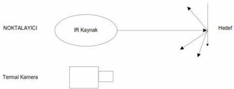
Şekil 2.7. IR Kaynak ile hedefin aydınlatması ve termal kameranın algılaması [2]
