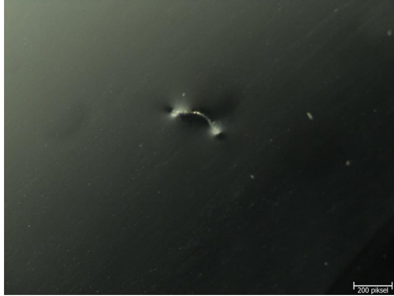
Şekil 3.23 Cam yünü hatasının mikroskop görüntüsü.
