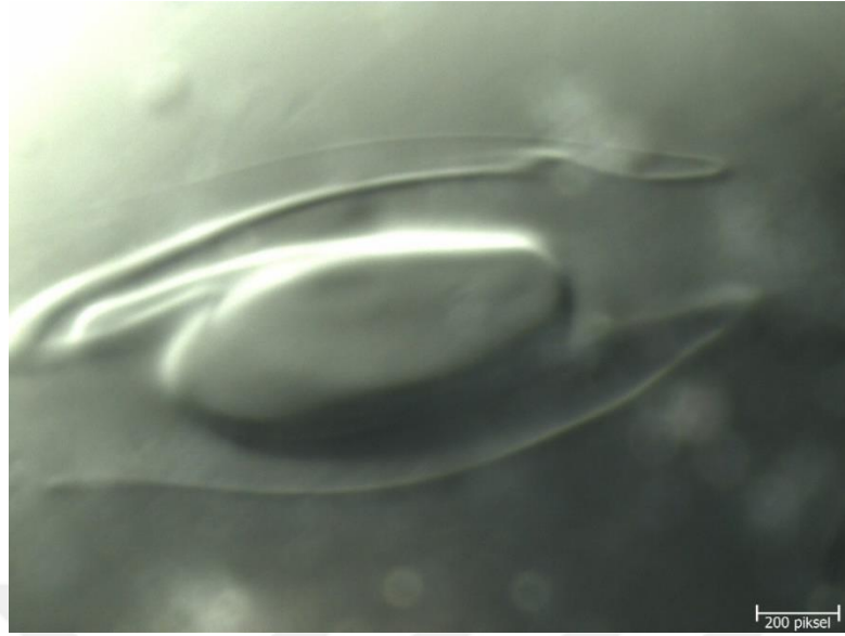
řekil 3.28 Ream hatasının mikroskop g r nt s .
