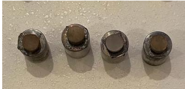
Şekil 3.10. SEM-EDS analizinden önce altın kaplama yapılan örneklerden bazıları
