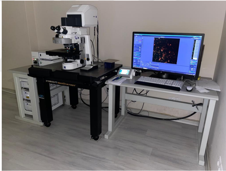
Şekil 3.27: Görüntülemeye kullanılan konfokal lazer taramalı mikroskop
