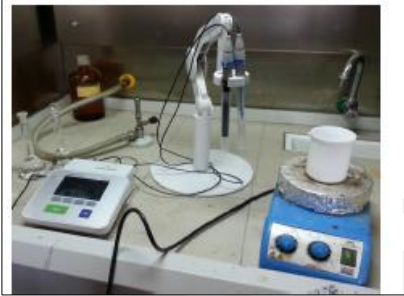
Resim 3.3. İyon metre, \text{BF}_4^- iyon seçici elektrot ve referans elektrot
