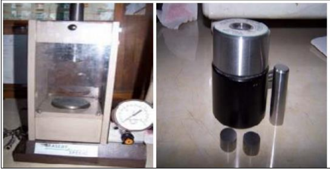
Resim 3.1. Pellet hazırlarken kullanılan ekipmanlar (presleme cihazı, pres kalıbı)
