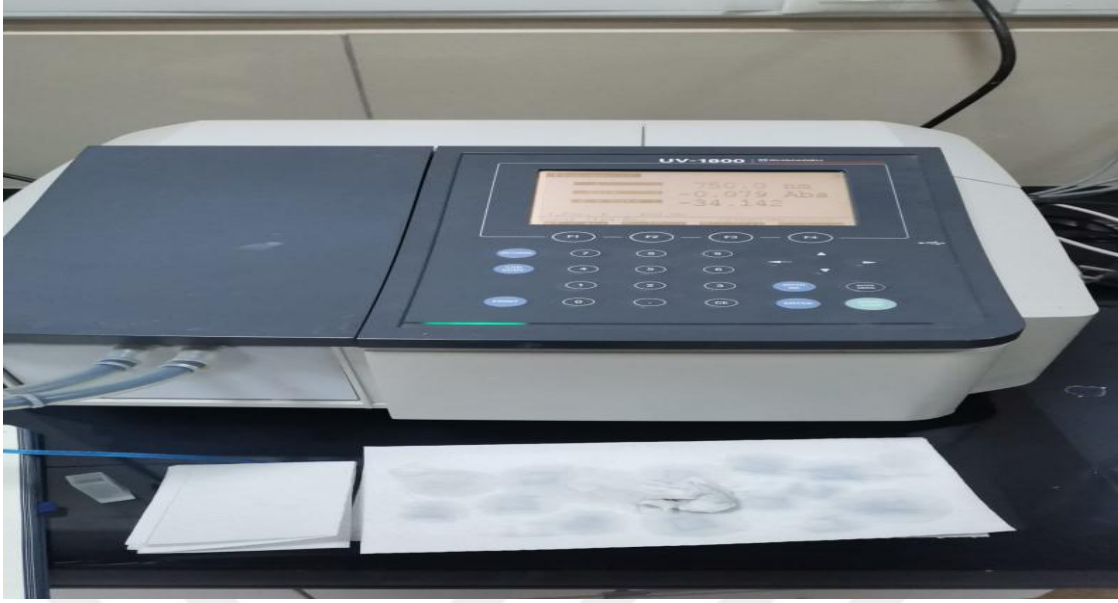
Görsel 3.2. Protein miktarının spektrofotometrede ölçülmesi
