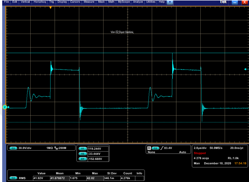
Şekil 9.10. V_{giriş}=32V , çıkış diyot gerilimi
