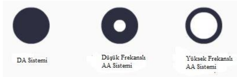
Şekil 3.7. Frekansa göre akımın kabloda ilerleyişi
