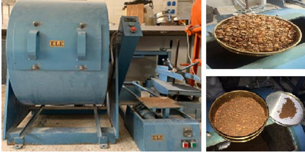
Şekil 3.1. Doğal takviye elemanlarının öğütülmesinde kullanılan aşınma cihazı
