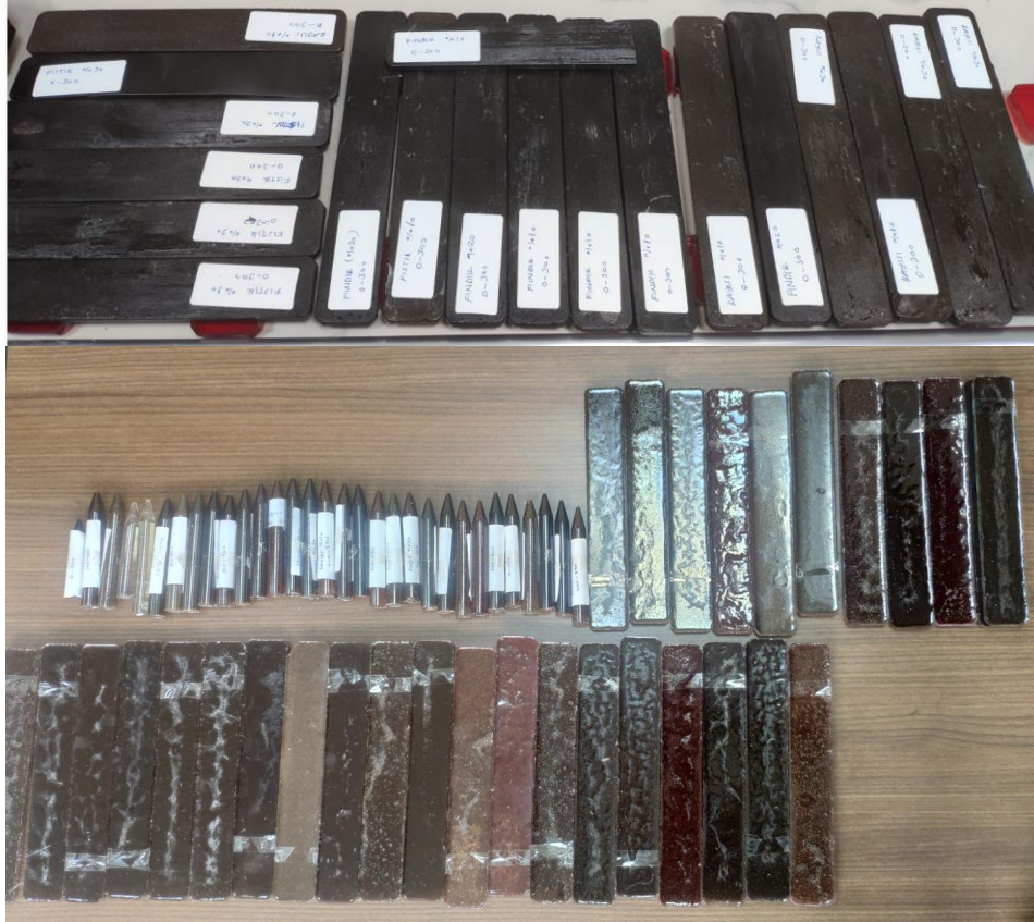
Şekil 3.11. Dikdörtgen ve silindirik kalıplardaki kompozit malzemeler
