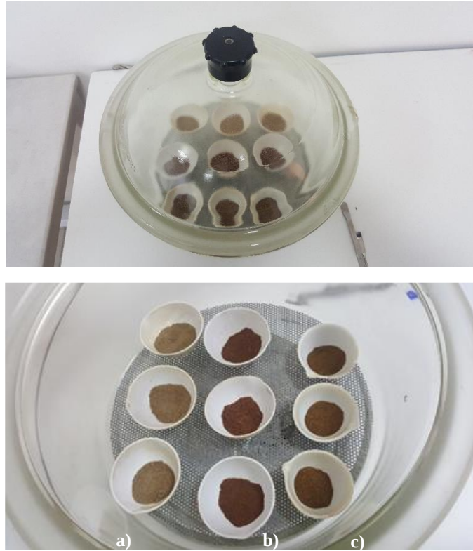
Şekil 3.4. Rutubet miktarının belirlenmesinde kullanılan toz partiküller a) Fındık kabuğu, b) Fındık kabuğu, c) Kayısı çekirdeği kabuğu
