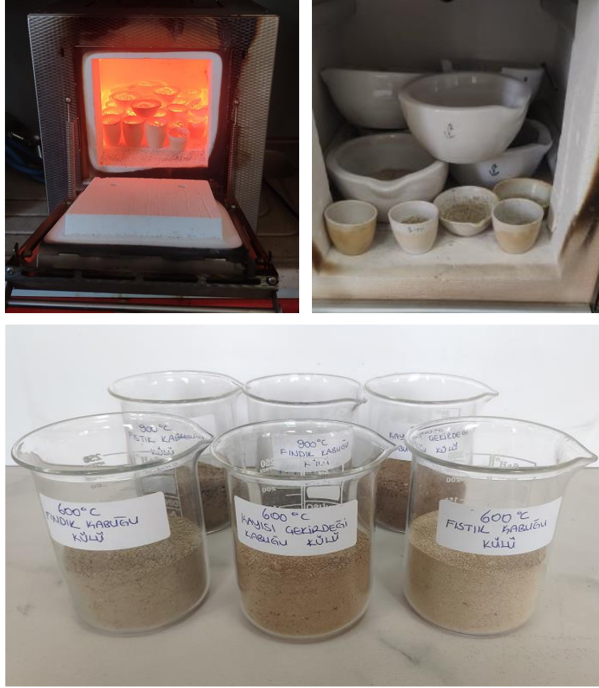
Şekil 3.3. 600 °C ve 900 °C’de kül haline getirilmiş toz partiküller
