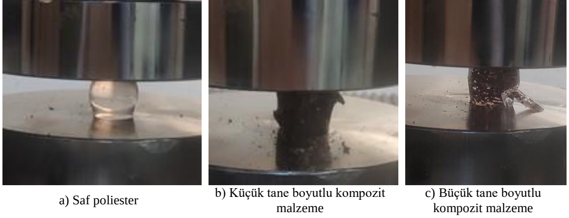
Şekil 4.40. Basma deneyinde meydana gelen deformasyonlar
