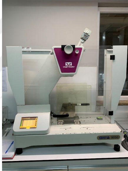
Şekil 3.6. Instron Ceast 9050 marka ızod darbe test cihazı
