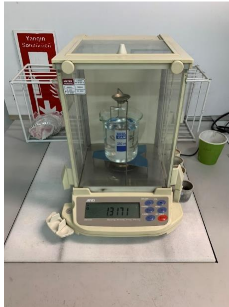
Şekil 3.8. AND GR 200 marka yoğunluk ölçüm cihazı
