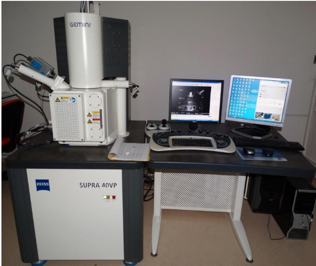
Şekil 3.13. ZEISS SUPRA 40VP SEM görüntüleme cihazı
