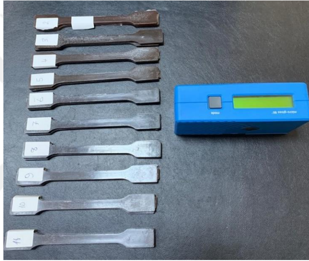
Şekil 3.10. Micro Gloss 60° (orta parlaklık) ölçüm cihazı
