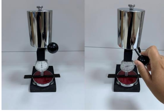
Şekil 3.7. LOYKA LX-D sertlik ölçüm cihazı
