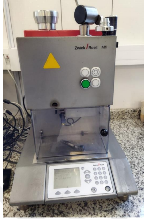
Şekil 2.12. Zwick Roell Marka MFI Ölçüm Cihazı
