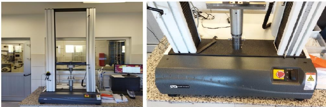
Şekil 2.8. Instron 3366 Marka Çekme Test Cihazı
