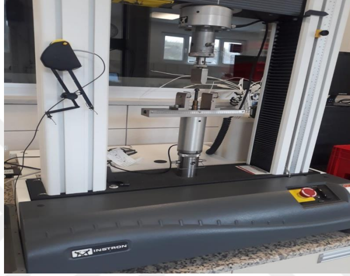
Şekil 2.9. Instron 3366 Marka Eğme Test Cihazı
