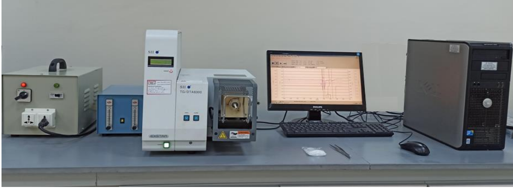
Şekil 2.17. Exstar TG/DTA 6300 Test Ölçüm Cihazı
