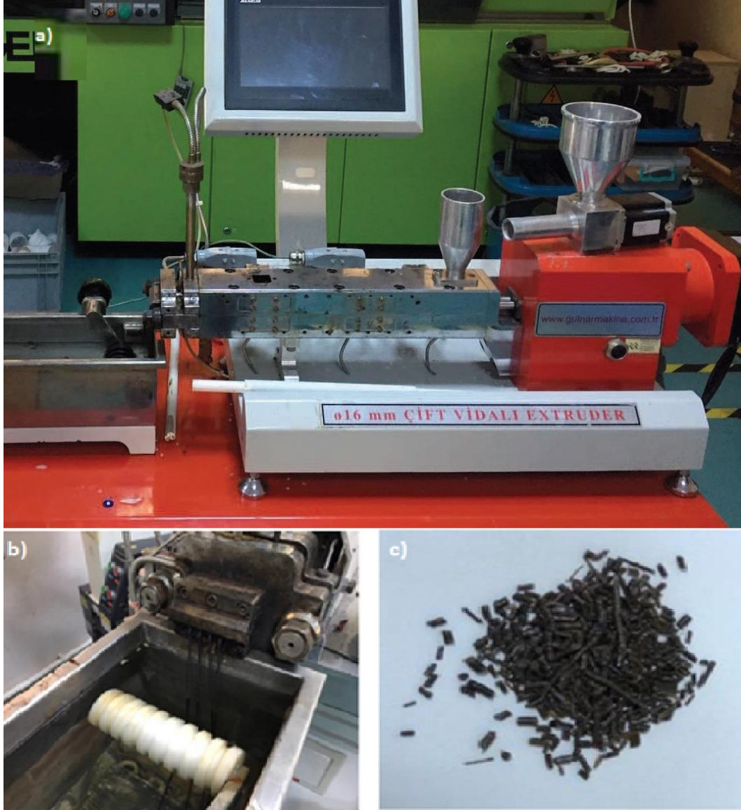
Şekil 2.5. a) ve b) Gülnar ekstrüder makinesi, c) Granül Hammadde
