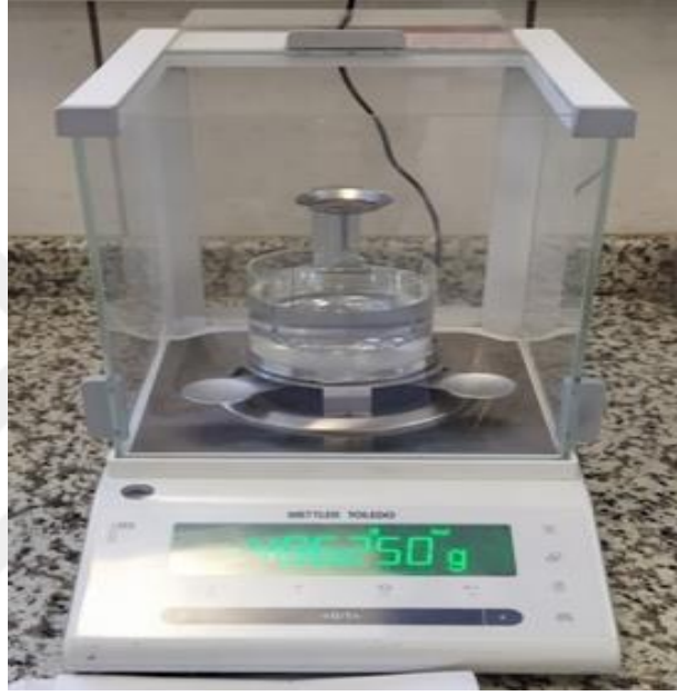
Şekil 2.11. Metler Toledo Marka Yoğunluk Ölçüm Cihazı
