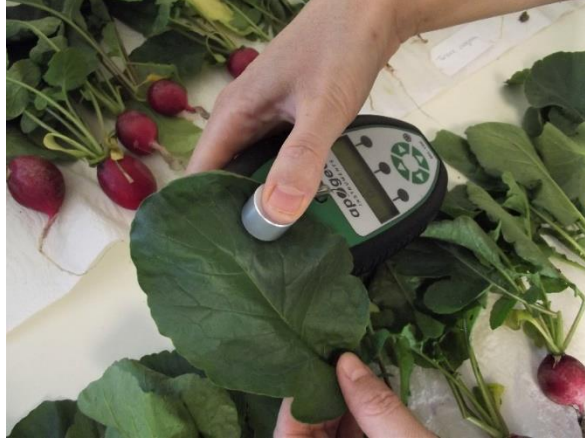
Fotoğraf 3.19. Klorofil miktarının ölçümü.
