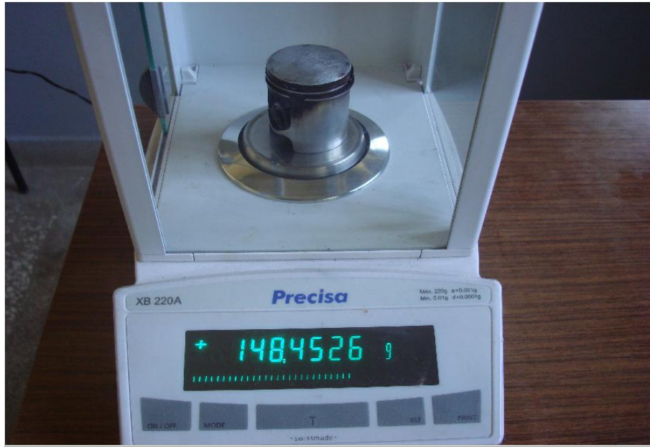
Şekil 2.13. Precisa XB 220A hassas terazi
