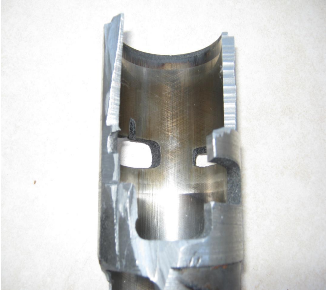
Şekil 3.1. Deney motorunun benzin-mineral yağ karışımı ile çalıştırılması sonuncu sökülen silindir görüntüsü
