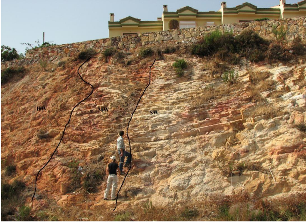
Şekil 4.4 Çalışma alanındaki tüflere ait ayrışma profilinden bir görünüm ( 4 88500/ 42 88300)
