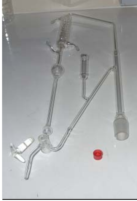
Şekil 3. Avrupa Farmakopesi'ne (6.0) uygun uçucu yağ elde edilen cihaz.
