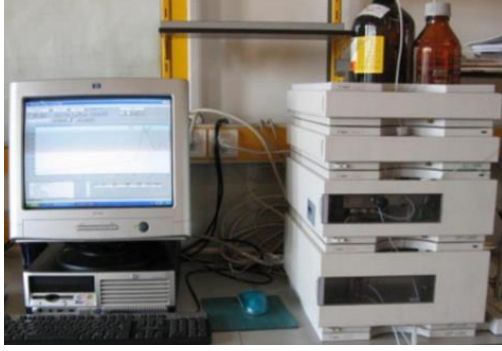
Şekil 4.3. a) PBZ polimerlerinin molekül ağırlığı ölçümlerinin yapıldığı GPC ölçüm cihazı, b) PBZ polimerlerinin güneş pili uygulamalarının yapıldığı potansiyostat cihazı.
