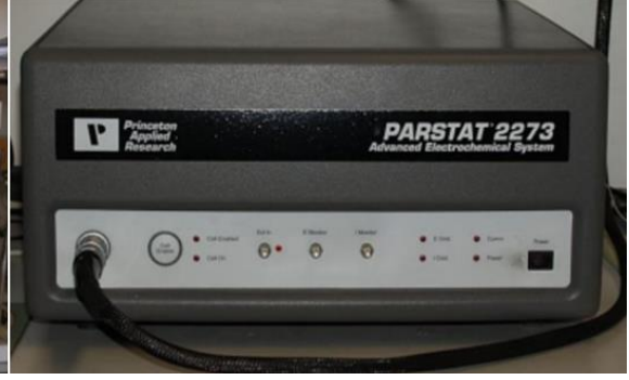
Şekil 4.3. a) PBZ polimerlerinin molekül ağırlığı ölçümlerinin yapıldığı GPC ölçüm cihazı, b) PBZ polimerlerinin güneş pili uygulamalarının yapıldığı potansiyostat cihazı.
