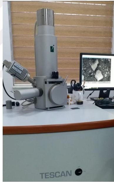
Şekil 4.4. PBZ polimerlerinin yüzeylerinin görüntülendiği SEM mikroskobu.
