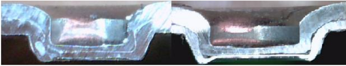
Şekil 5.7 TSE EN ISO 14270 Standardına uygun yapılan deneylerdeki iyi ve kötü birleştirme kesitleri
