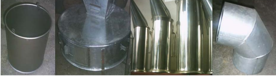
Őekil 2.24 Kenetli birleřtirme ile imal edilmiř para rnekleri (İnt.Kyn.4).
