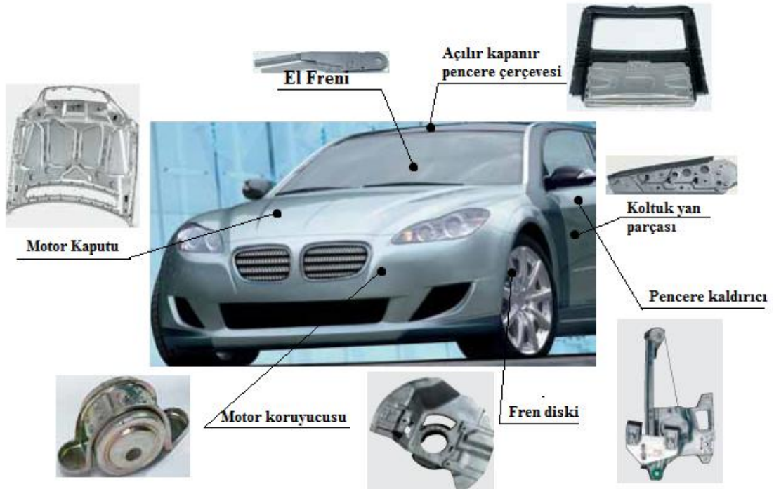
Şekil 2.39 Form punta sisteminin bir otomobilde kullanıldığı yerlerin genel görünümü (İnt.Kyn.11).
