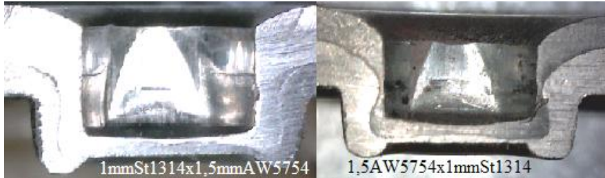
Şekil 4.8 1 mm St1314 ile AW5754 arasında yapılan bağlantı kesitleri
