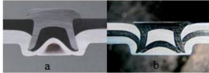
Şekil 2.32 a) Plastik-alüminyum iki katmanlı birleştirme b) Alüminyum-çelik-alüminyum üç katmanlı birleştirme (İnt.Kyn.12).
