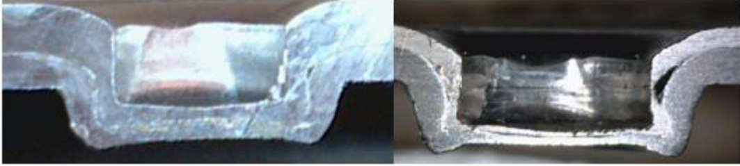
Şekil 5.6 TSE EN ISO 14273 Standardına uygun yapılan deneylerdeki iyi ve kötü birleştirme kesitleri
