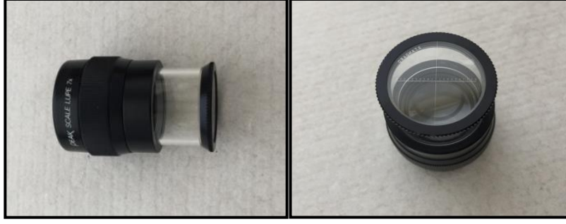
Resim 36. MPI loop'unun yandan ve alttan görünümü
