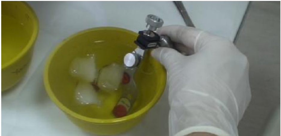
Şekil 3.10. Isırma çatalının buzlu suda soğutulması
