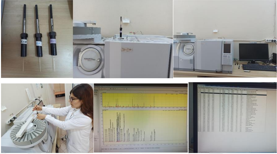
Şekil 3.4. Aroma Bileşiklerinin Headspace SPME GC-MS cihazı ile analiz aşamasından görüntüler
