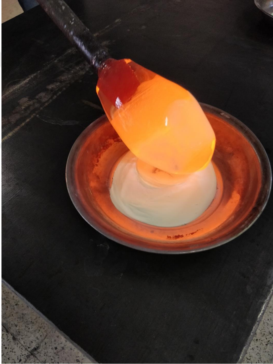
Görsel 5.17. İkinci katman fosforesans pigment kaplanması (Fotoğraf: Ufuk Ramazan Akbey)
