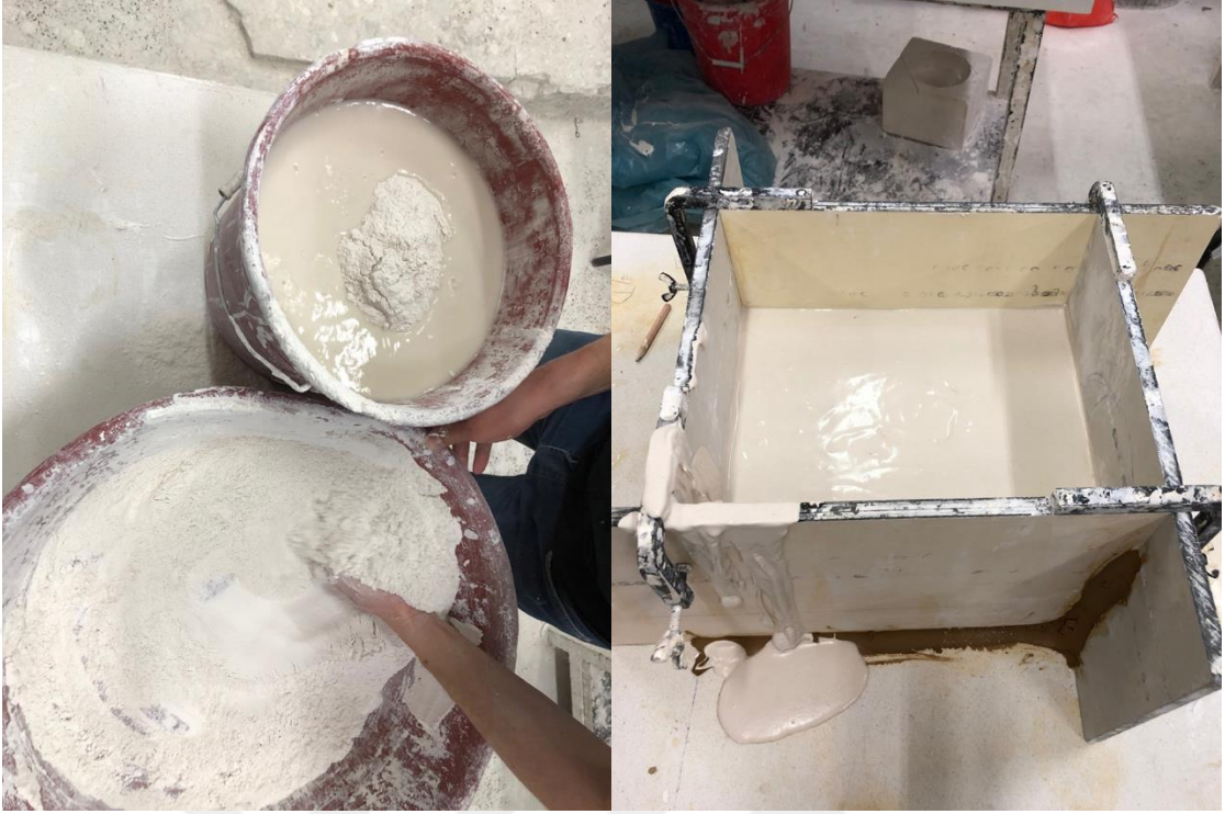
Görsel 5.30. Alçı kuvars kalıp malzemesi hazırlanması ve model üzerine dökülmesi (Fotoğraf: Ufuk Ramazan Akbey)
