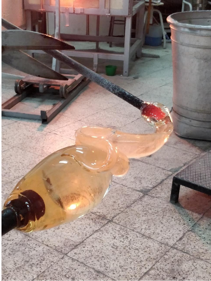
Görsel 5.25. Fosforesans pigmentlerle kuzey ışıkları deseni oluşturulması (Fotoğraf: Ufuk Ramazan Akbey)
