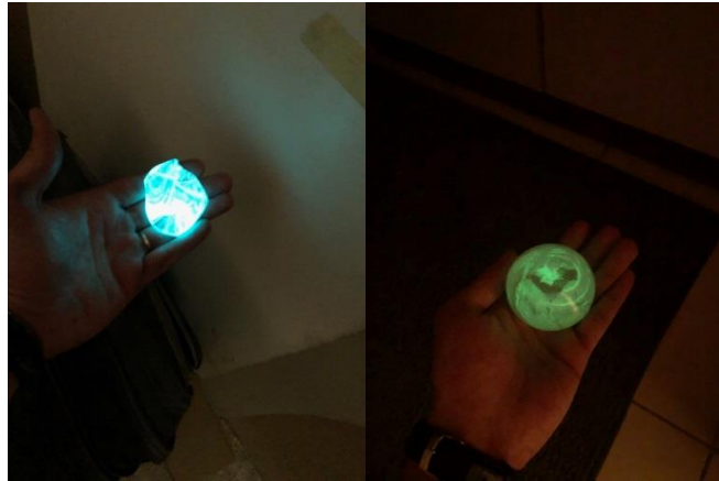
Görsel 5.26. Kimyasal saflık oranlarına göre fosforesans pigmentlerin cam içerisinde ışık yaymaları (Fotoğraf: Ufuk Ramazan Akbey)
