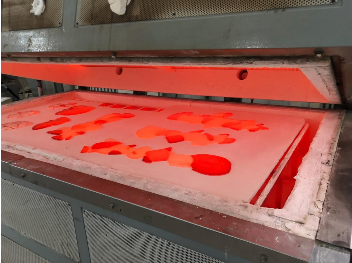
Görsel 5.34. Parçaların fırın içerisinde ısı ile birleşme aşaması (Fotoğraf: Ufuk Ramazan Akbey)
