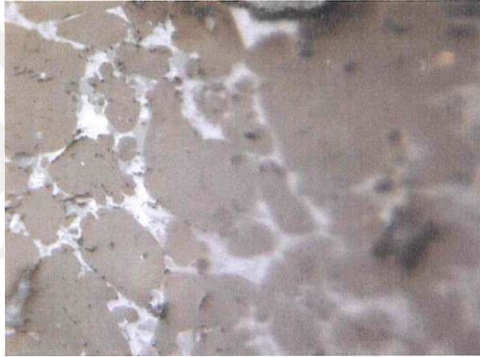
Şekil 4.2. Klinker 500x büyütme; ham karışım kaynaklı etkiler
