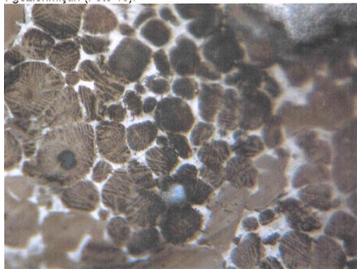
Şekil 4.9. Klinker 200x büyültme, belit lamelleri
