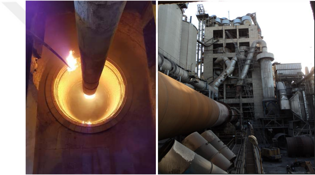
řekil 1.6. Klinker retiminde yakıt kullanımı (Alev borusu)
