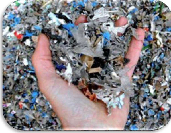
Şekil 3.15. Atıktan türetilmiş yakıt~3500 Kcal/kg
