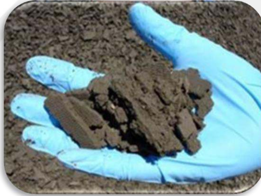
Şekil 3.19. Kurutulmuş Arıtma Çamuru ~2500 kcal/kg
