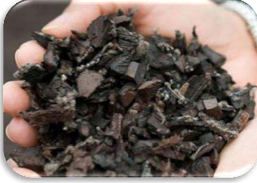
Şekil 3.11. Kırpılmış atık lastik görüntüsü (~6100 kcal/kg)
