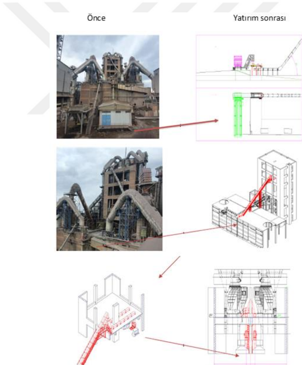
Şekil 3.12. Kırpılmış atık lastik besleme hattı yatırımı teknik görseli
