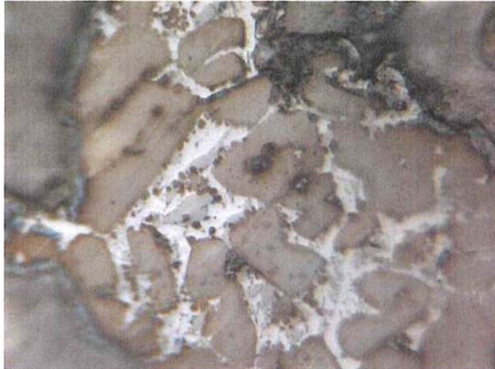
Şekil 4.20. 500x büyütme (kahverengi açık kahverengi kristaller alit, krem rengi zemin üzerindeki gri kristaller C_3A mineralleridir.
