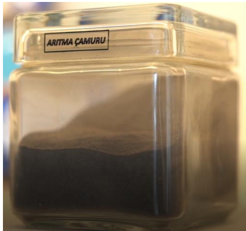
Şekil 3.20. Kurutulmuş Arıtma Çamuru Üretim Prosesin ~2500 kcal/kg
