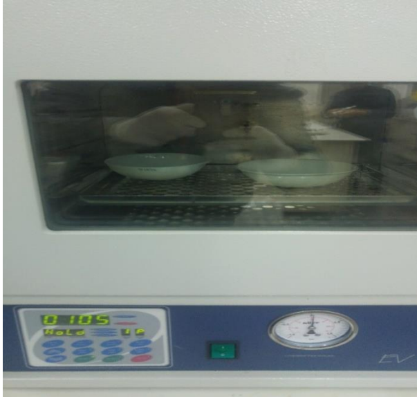
Şekil 3.4. Diş numunelerindeki nemi almak için fırınlanırken.
