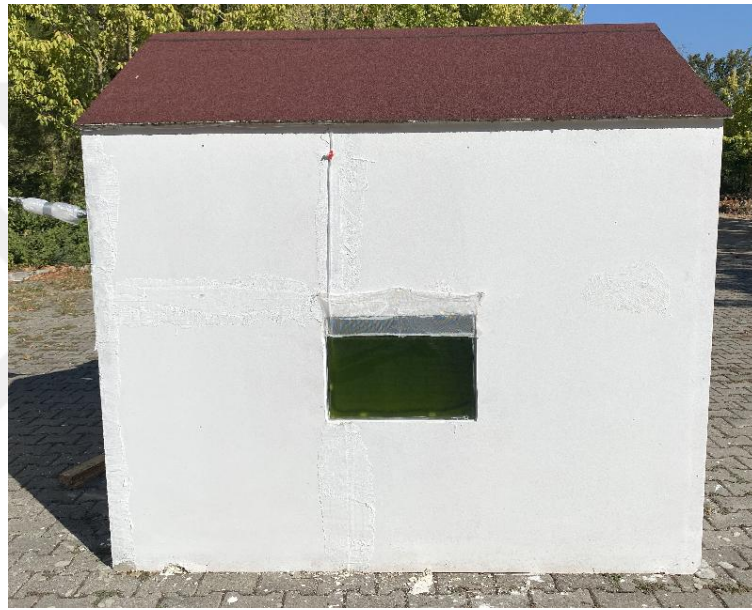
Şekil 3.5. Fotobiyoreaktör pencere sisteminin entegre edildiği 1/2 ölçekli yapı
