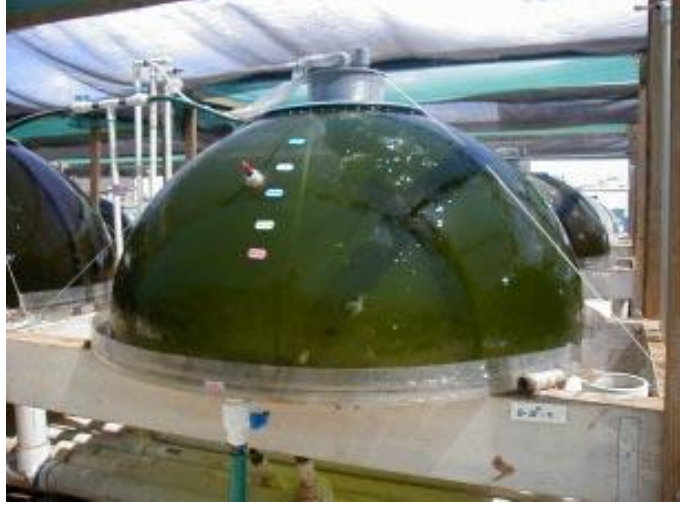
Şekil 20. Micro Gaia tarafından inşa edilen kubbe fotobiyoreaktör, Hawaii (Olaizola & Huntley, 2003)
