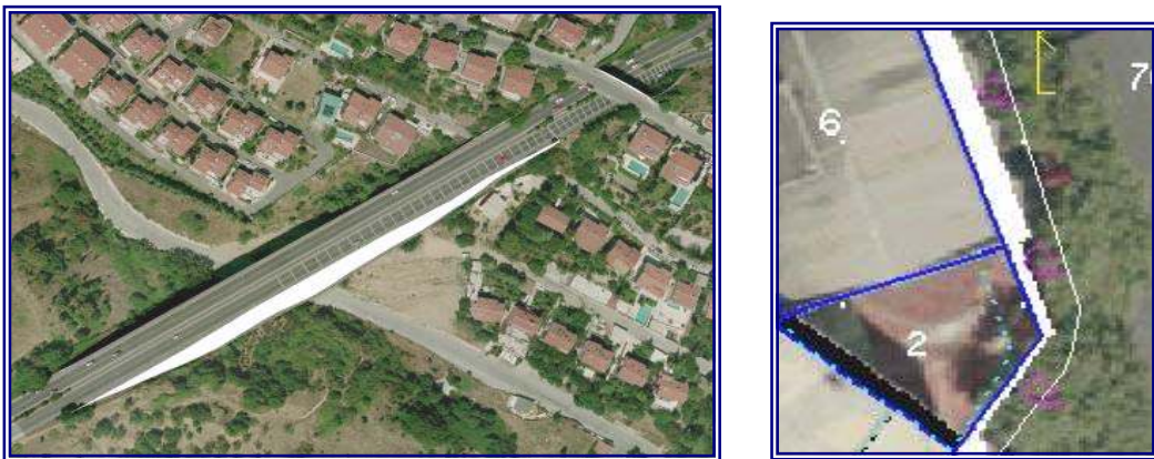
Şekil 5.2 Gerçek Ortofoto üretilmesi durumunda görüntüde oluşan boşluklar
