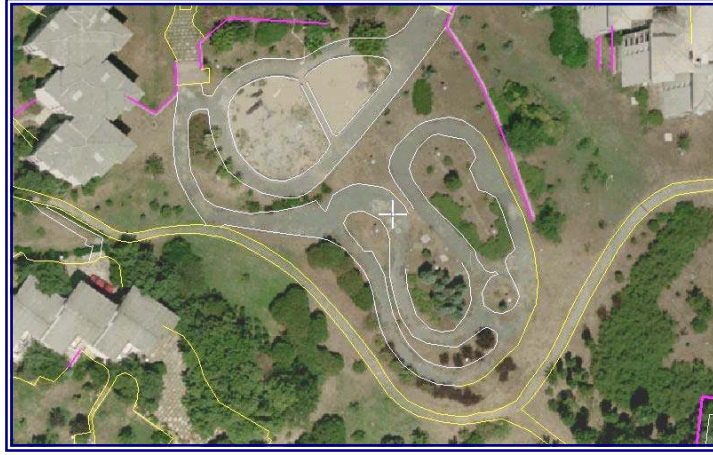
Şekil 5.1 Sayısal ortofoto üzerinden sayısallaştırma işlemi
