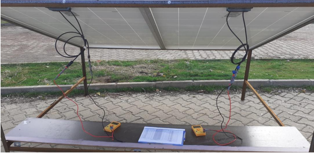
Şekil 5.4. Kısa devre akımı ve açık devre gerilimi ölçümü
