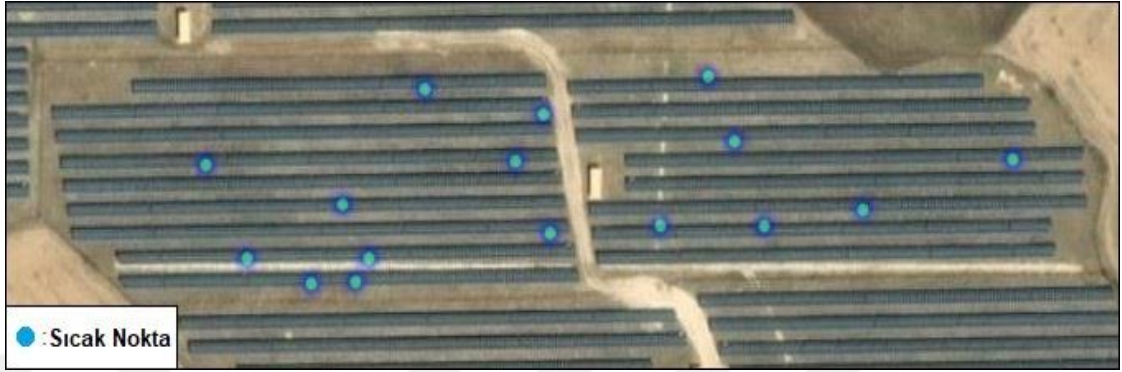
Şekil 4.2. EXIF verileri ile konumları belirlenen sıcak nokta arızalarının ısı haritası
