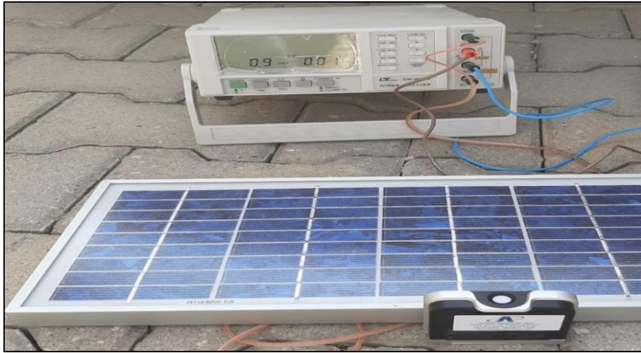
Şekil 4.1. Fotovoltaik panel için istenilen verilerin ölçümü
