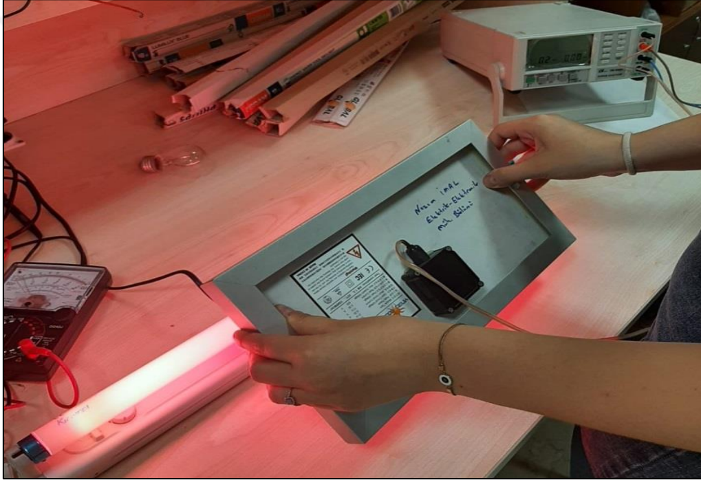
Şekil 4.2. Kırmızı floresan lamba için istenilen verilerin ölçümü
