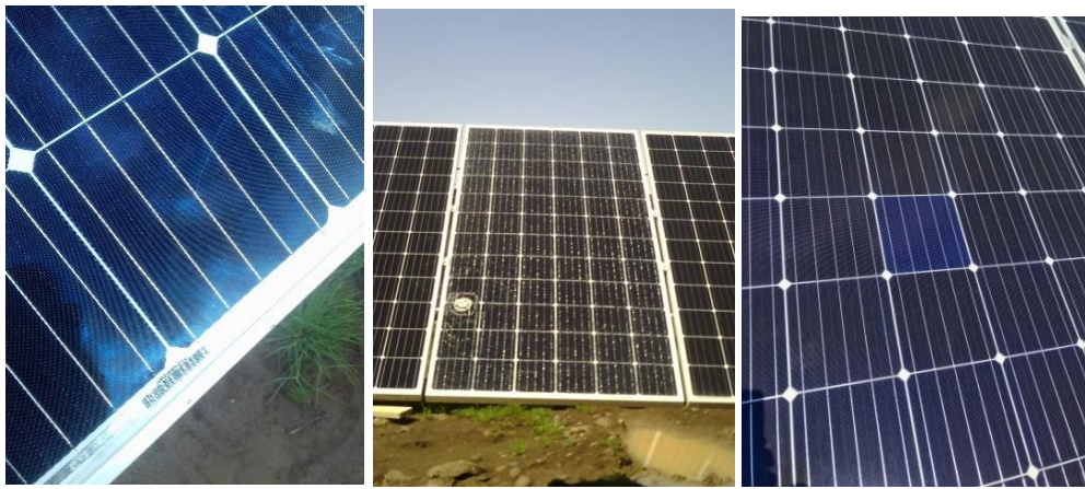
Şekil 5.26: Sahada ki Çizik, Kırık ve Renk Farklılığı Olan Paneller
