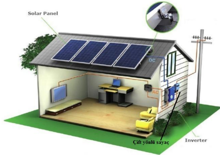
Şekil 3.2 On-grid bir sistem [24]
