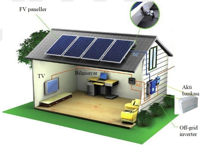
Şekil 3.85 Fotovoltaik off-grid sistemin bileşenleri [26]
