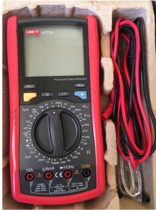
Şekil 3.15. UNI-T UT70A Dijital Multimetre görüntüsü
