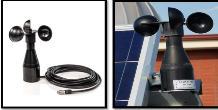
Şekil 3.14. Rüzgâr hızı ölçer (rüzgâr sensörü) ( https://www.solar-log.com )
