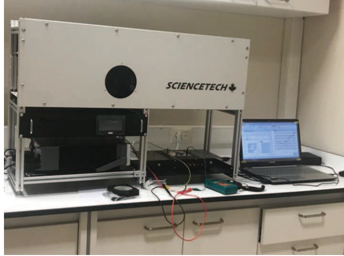
Şekil 3.1. Deneylerde kullanılan solar simülatör cihazı.
