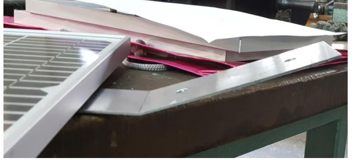
Şekil 3.4: Uygun açılarda bükülmüş panel montaj elemanları
