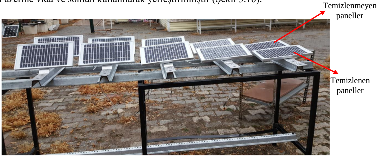
Şekil 3.10: Panel kablolama işlemi sonrası taşıyıcı sistemin görünümü
