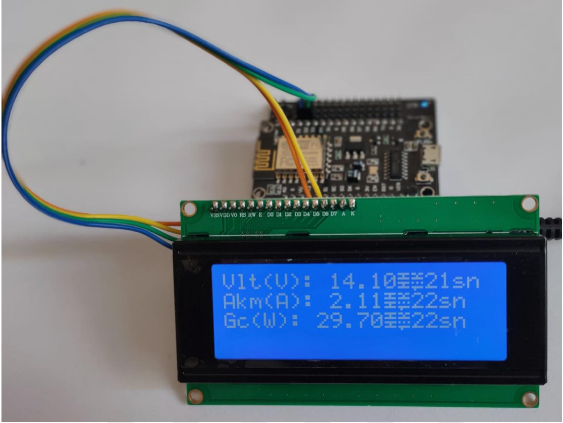
Şekil 4.4 LCD ekran güç verileri.
