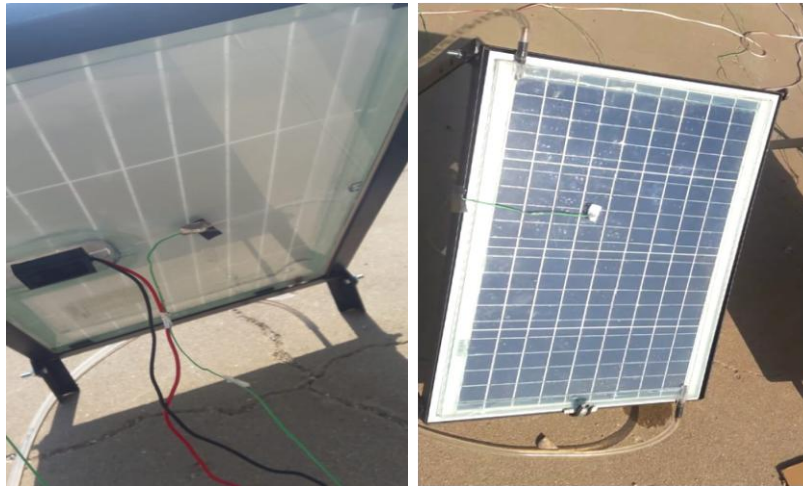
Şekil 3.5. Panel Alt ve Üst Yüzeylerine Sızdırmaz Çift Camın Yerleştirilmesi
