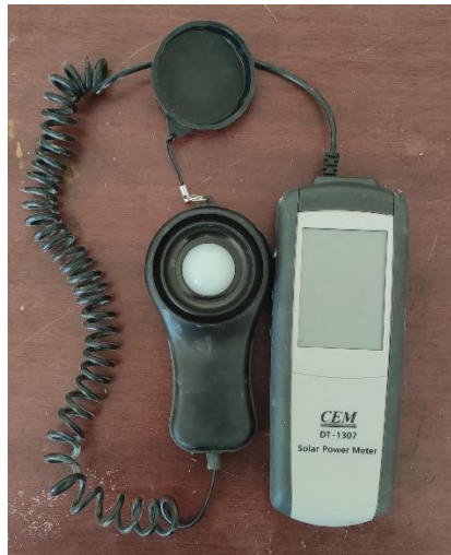
Şekil 3.12. Piranometre (Solar metre)
