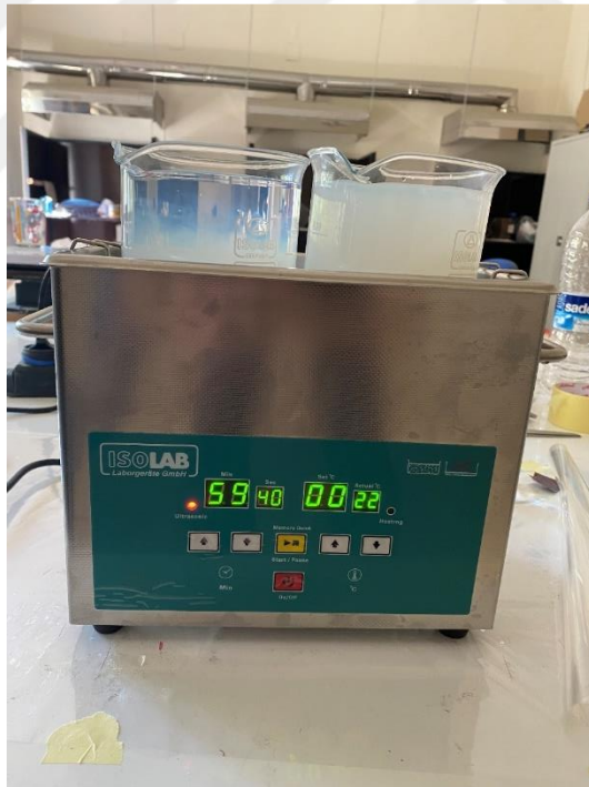
Şekil 3.6. Nanoakışkan homojenizasyonu için ultrasonik banyoda karıştırma
