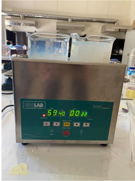
Şekil 3.6. Nanoakışkan homojenizasyonu için ultrasonik banyoda karıştırma
